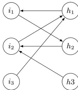
Dans ce graphe, on a un seul circuit :  $(i_1, h_2, i_2, h_1, i_1)$ . On obtient donc le mariage  $\{(i_1, h_2), (i_2, h_1)\}$ . À l'itération suivante, on a le graphe suivant :
