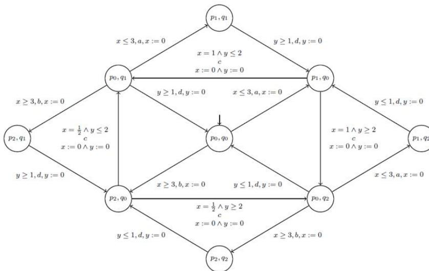
FIGURE 1 – Composition des automates A et B
